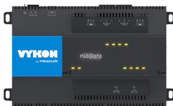
Niagara コントローラ「JACE@9000」とグラフィックのサンプル画面
